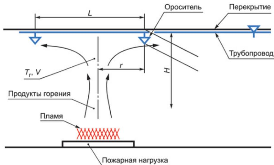
Рисунок B.1 - Расчетная схема
